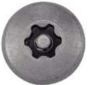
TETE CYLINDRIQUE LARGE SIX LOBES INVIOLEABLE AVEC TETON CENTRAL POUR PENTURES
