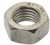
REF : A4-617 ECROUS AUTOFREINES HEXAGONAUX - TOUT METAL DIN 980
