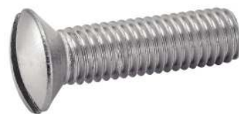
REF : A2-209 VIS A METAUX TETE FRAISEE BOMBEE FENDUE ISO 2010 - DIN 964
