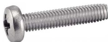
REF : A2-222 VIS AUTOTARAUDEUSES TETE CYLINDRIQUE POZIDRIVE DIN 7500 CZ
