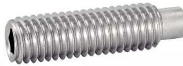
REF : A2-206 VIS SANS TETE SIX PANS CREUX BOUT TETON LONG ISO 4028 - DIN 915
