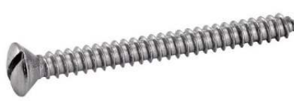
REF : A2-404 VIS A TOLE TETE FRAISEE BOMBEE FENDUE ISO 1483 - DIN 7973
