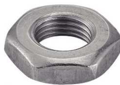
REF : A2-624 ECROUS BAS HEXAGONAUX FILETAGE METRIQUE PAS FIN ISO 8675 - DIN 439
