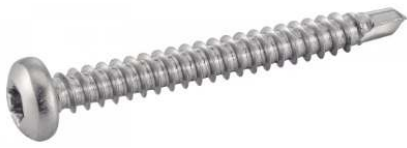
REF : A2-435 VIS AUTOPERCEUSES TETE CYLINDRIQUE SIX LOBES DIN 7504 M
