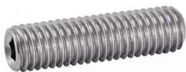
REF : A2-204 VIS SANS TETE SIX PANS CREUX BOUT PLAT ISO 4026 - DIN 913
